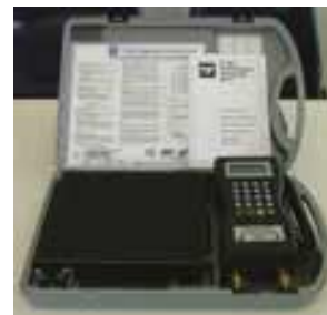
Рисунок 9. Оборудование для заправки хладагента
